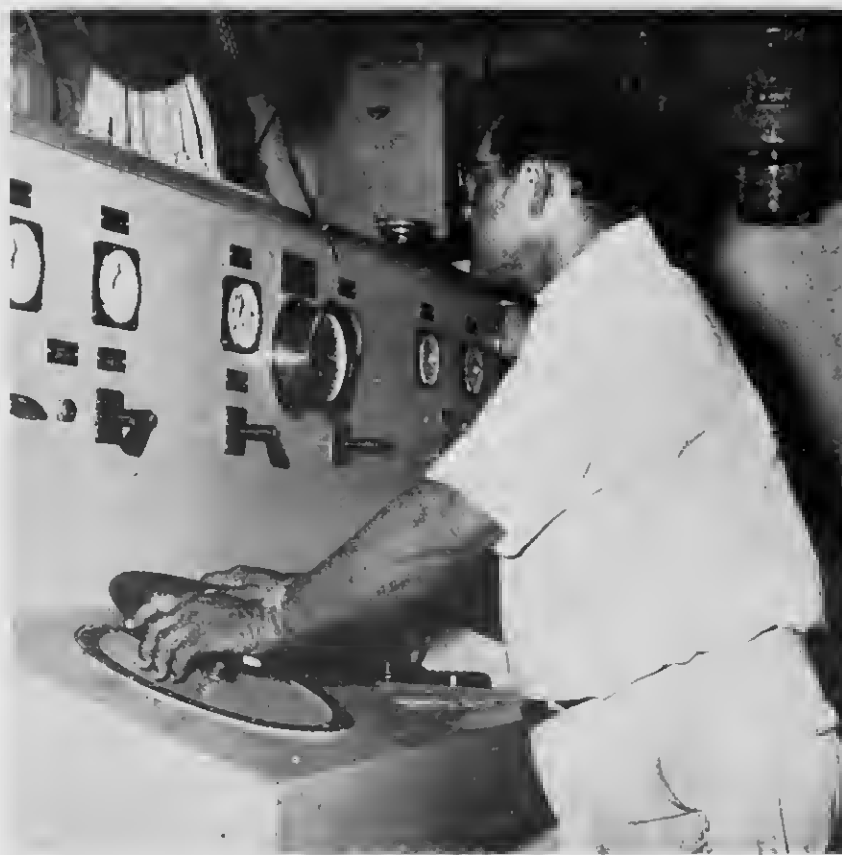
CONTROLANDO e forza, e maquinista ta warda un senjal ariba e telegraaf for di e captan den su cabina.
